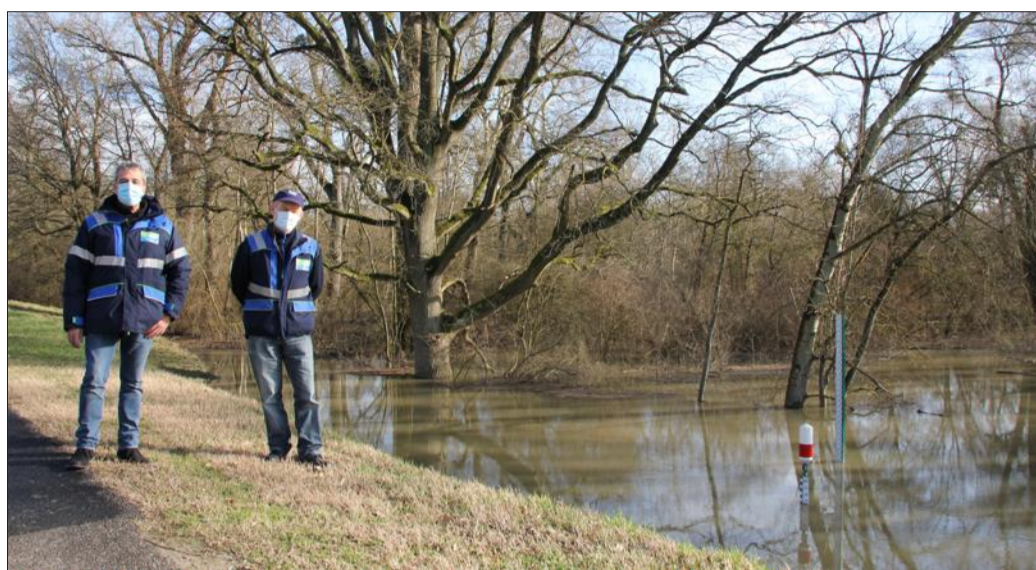
Les responsables VNF du secteur, Jean-Claude Bury (à gauche) et son adjoint Michel Keller, relèvent les niveaux du Rhin grâce à des échelles : la petite mesure le niveau en mètres, mais, trop courte, elle sera supprimée au profit de la plus grande qui mesure l'altitude de la crue par rapport au niveau zéro. Photos DNA/V.KO.
